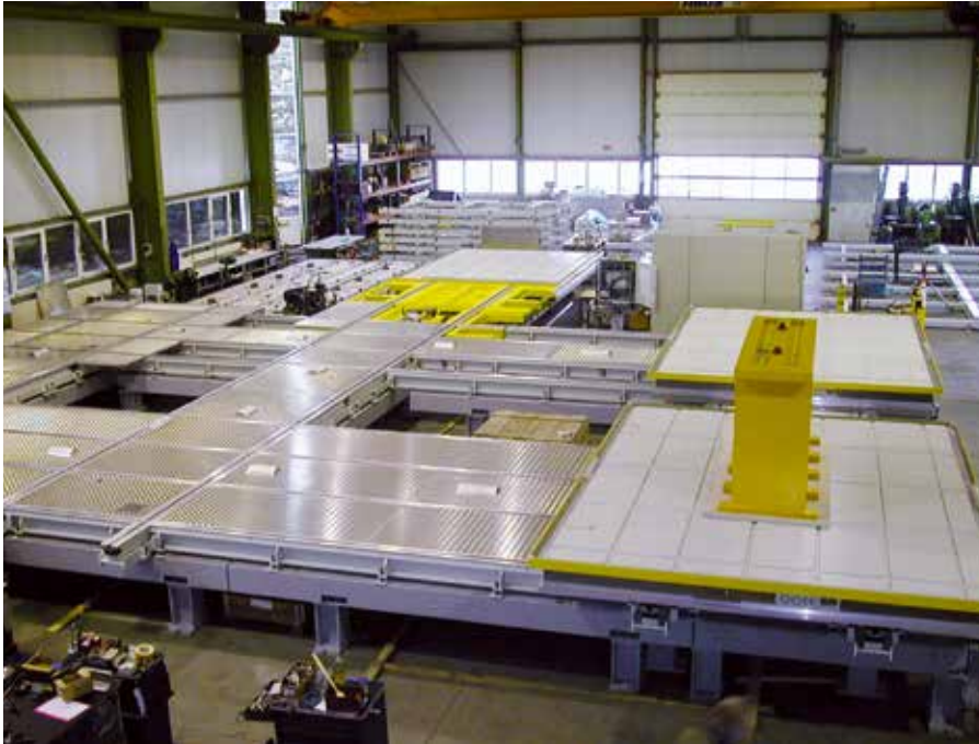
Werkstück- Servier- und Lagersystem (horizontal) Palettengröße 3200 × 4200 mm
