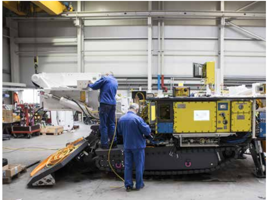
Inbetriebnahme einer Teilschnittmaschine
