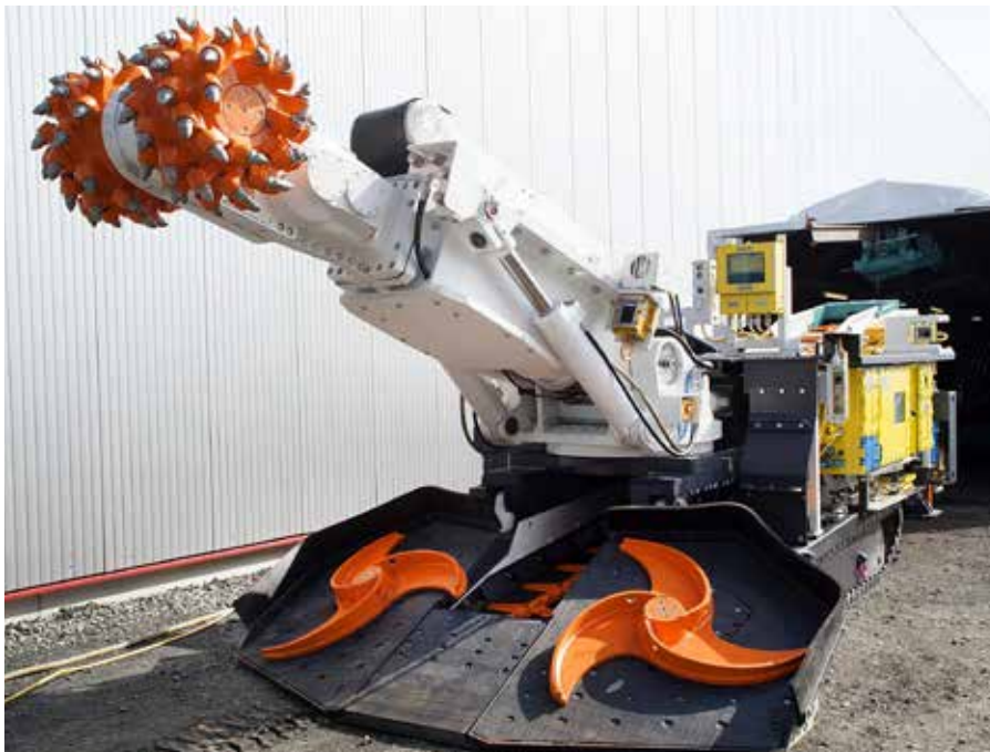
Teilschnittmaschine für den Einsatz im Berg- und Tunnelbau
