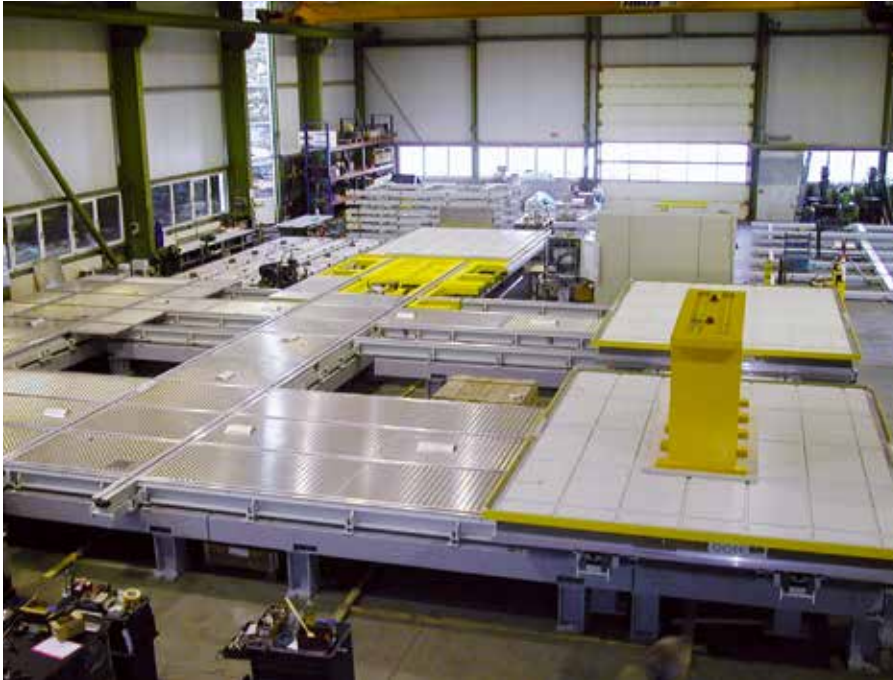
Werkstück- Servier- und Lagersystem (horizontal) Palettengröße 3200 x 4200 mm
