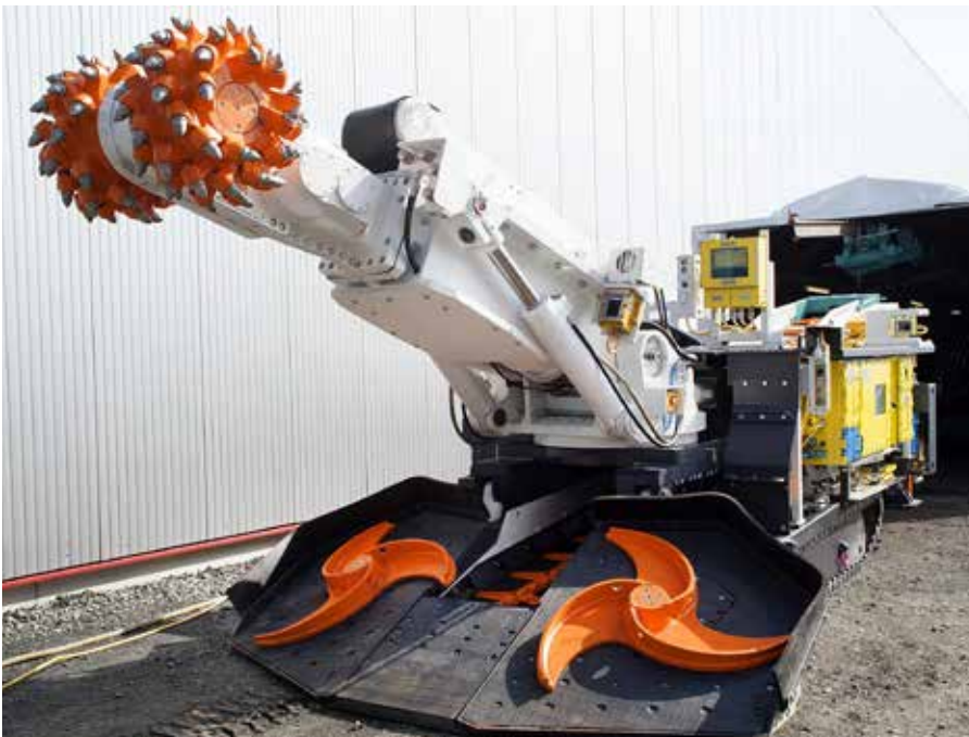
SM150 für Kohlebergbau mit Radarsystem iRoadheader
