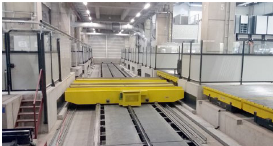
Einen hocheffizienten und leistungsstarken Palettenwechsler hat das Bischofsheimer Unternehmen MSB Sondermaschinenbau für Mercedes-Benz entwickelt. (Foto: Schmitt Werke GmbH)
