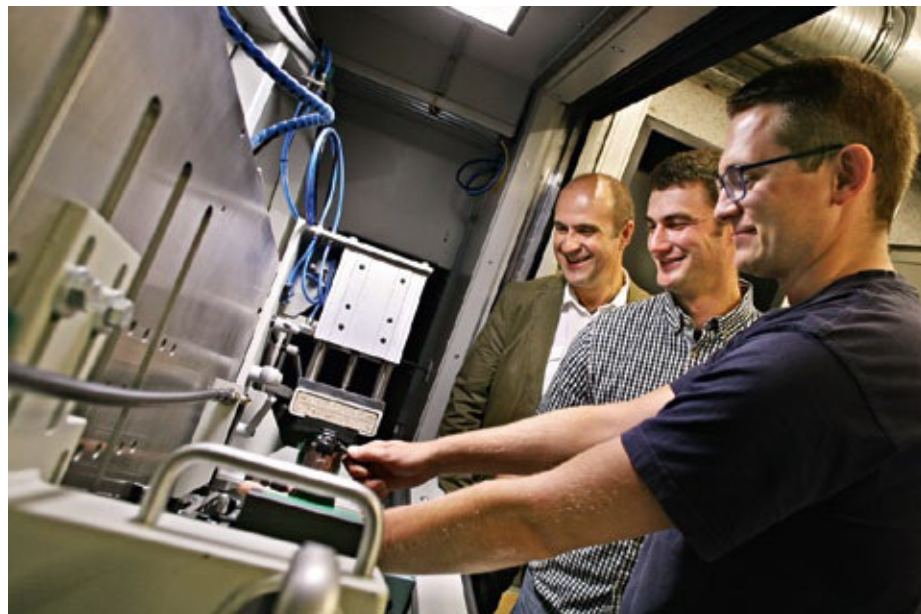
Stolz auf den ersten exklusiv entwickelten Waffenprüfstand sind (von links) Jürgen Enders und Michael Tulit vom Bischofsheimer Unternehmen MSB Sondermaschinenbau sowie Christian Albert vom Staatlichen Beschussamt in Mellrichstadt. Hier im Bild die Einspannvorrichtung für den hochkomplexen Langwaffenprüfstand. (Foto: Schmitt Werke GmbH/Kerstin Junker)
